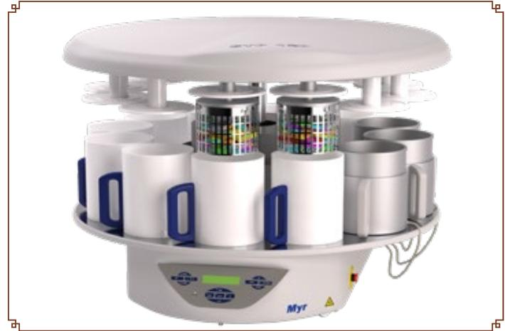
con una agitación vertical opcional que hace ascender y descender las muestras. Al final, la cesta realiza un centrifugado de las muestras a 120 rpm para evitar el arrastre de reactivos.
