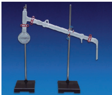
1 | Fabricado en vidrio borosilicato con uniones esmeriladas 29/32.
